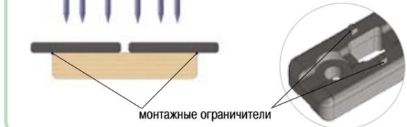
**3 Монтаж первой доски.** Выбираем наиболее удобный вариант крепления (торцевого или бокового) первой доски. Крепим саморезами №1 на первую доску стартовый ДУЭТ и один элемент крепежа ДУЭТ 90. Через монтажные отверстия стартового ДУЭТа и ДУЭТа 90 саморезами №2 крепим первую доску к лагам террасы.
