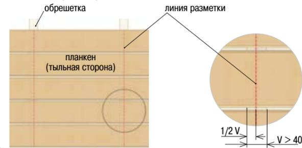
**2 Монтаж крепежа на рядовую доску.** Устанавливаем крепеж ДУЭТ 70 вдоль линии разметки и фиксируем его саморезами №1 рекомендуемого размера. Для позиционирования крепежа ДУЭТ 70 относительно края доски пользуемся монтажными ограничителями.
