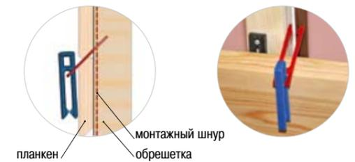
Сборка А-спейсеров «цепочка» для формирования монтажных зазоров между досок
