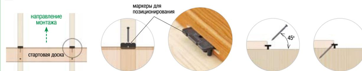
**3** Вторая доска устанавливается пазом вплотную к крепежу TERRA. Крепеж создает начальный монтажный зазор 5 мм.
